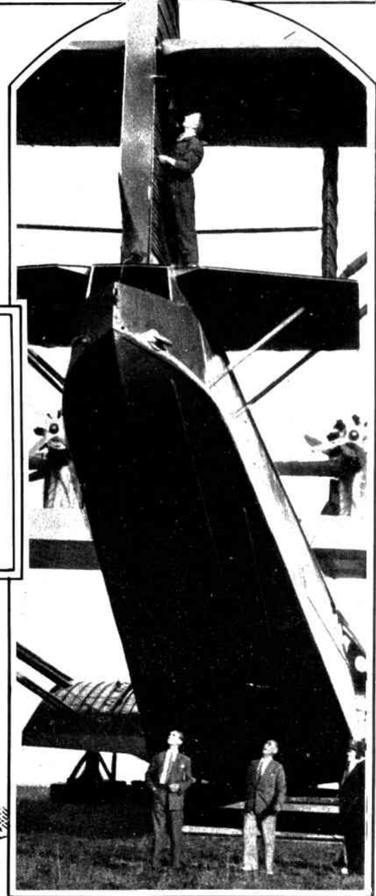
LA COLA: vista de popa del "Do.X". Las figuras de los hombres permiten apreciar las dimensiones del aparato. En las pruebas finales el hidroavión pesó 36.5 toneladas, con veinte y cinco personas a bordo.
